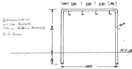
**aus 40 x 2 mm Messingrohr, Haken aus 6 x 30mm Flachmessing,**
